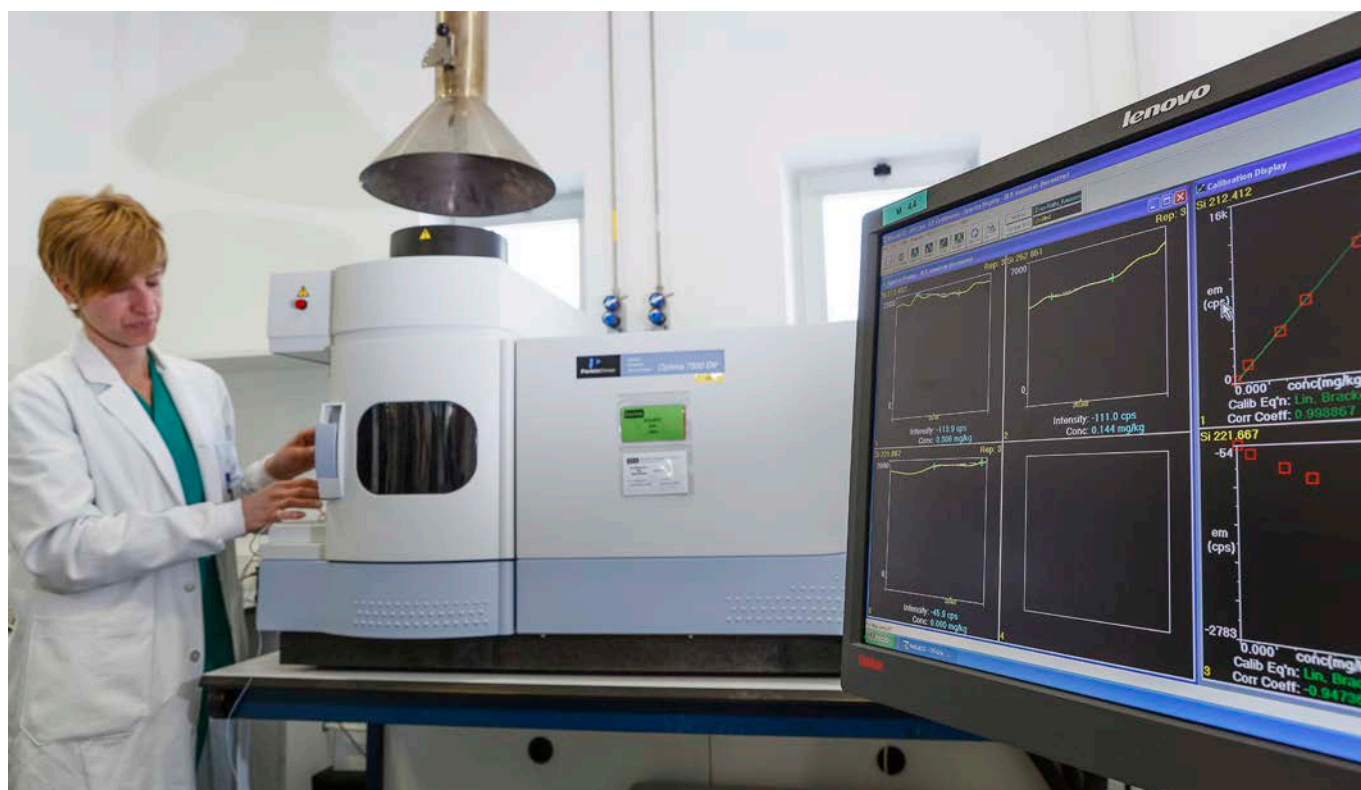
Equipo cromatográfico de Intertek para determinar la composición del biogás y las constantes características de cada gas.
